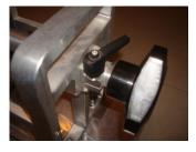
Manillar de giro con freno para detener en el ángulo deseado
